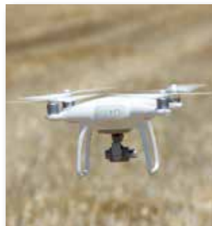
Εικόνες 3α, 3β, 3γ & 3δ: Εξοπλισμός εναέριας αποτύπωσης (Εναέριο όχημα Phantom 3 Pro)
