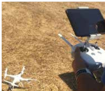
Εικόνες 3α, 3β, 3γ & 3δ: Εξοπλισμός εναέριας αποτύπωσης (Εναέριο όχημα Phantom 3 Pro)
