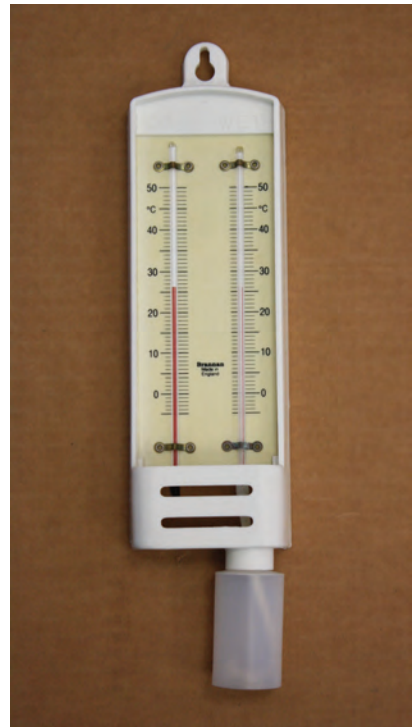
Εικόνα 7: Θερμόμετρο ξηρού και υγρού βολβού για προσδιορισμό της σχετικής υγρασίας σε ψυκτικούς θαλάμους διατήρησης μήλων. (Εργαστήριο Μετασυλλεκτικής Τεχνολογίας, ΙΓΕ)
