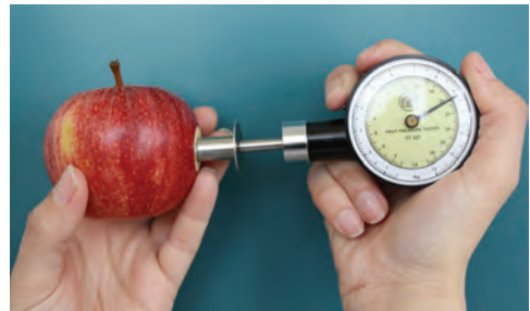
Εικόνα 3: Μέτρηση συνεκτικότητας μήλου με πιενοτρόμετρο τύπου Effegi. (Εργαστήριο Μετασυλλεκτικής Τεχνολογίας, ΙΓΕ)
