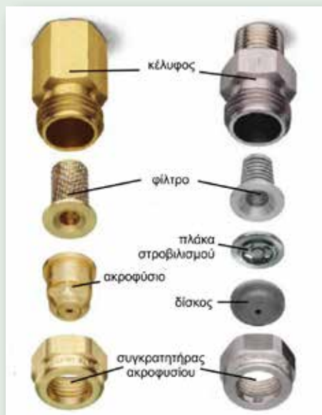
Κύρια κατασκευαστικά στοιχεία ενός εκτοξευτήρα (μπεκ) με υδραυλικά ακροφύσια πλήρους κώνου (αριστερά) και κούλου κώνου (δεξιά)
