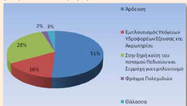
Γράφημα 1: Διάθεση επεξεργασμένων αστικών λυμάτων στο πλαίσιο εφαρμογής της Οδηγίας 91/271/ΕΟΚ για την επεξεργασία αστικών λυμάτων, κατάσταση 31.12.2016
