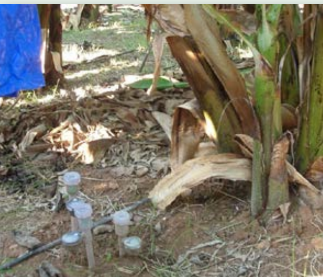
Εικόνα 3. Τοποθέτηση τενσιόμετρων σε φυτεία με μπανάνες
