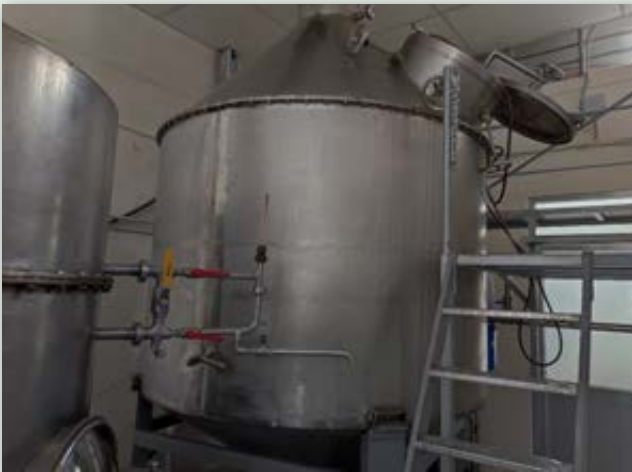
Καζάνι για απόσταξη ροδοστάγματος. Φαίνεται η είσοδος τριαντάφυλλων και νερού.
