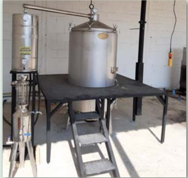
Αποστακτήρας για την εξαγωγή αιθέρων ελαίων
