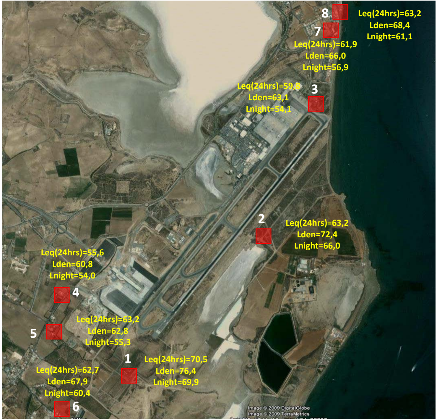
Σχήμα 5.6 : Θέσεις 24ώρων ακουστικών μετρήσεων στο Αεροδρόμιο Λάρνακας
