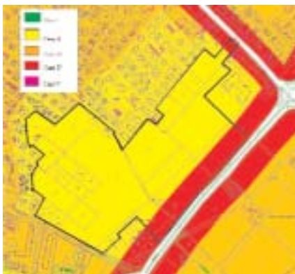
Figure 5: Acoustical zoning of Via della Pietra area
