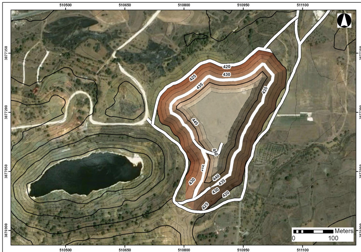
Σχήμα 3.1-5: Χάρτης Περιοχής Έργου, μετά από τελική διαμόρφωση του προς αποκατάσταση σωρού στείρων με γωνία πρανούς 27°.
