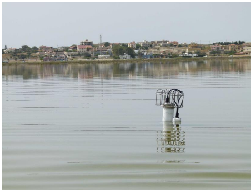
Εικόνα 14. Το όργανο μέτρησης φυσικών και χημικών παραμέτρων (Idronaut CTD 316 Plus), που χρησιμοποιήθηκε κατά τις φετινές δειγματοληψίες.
