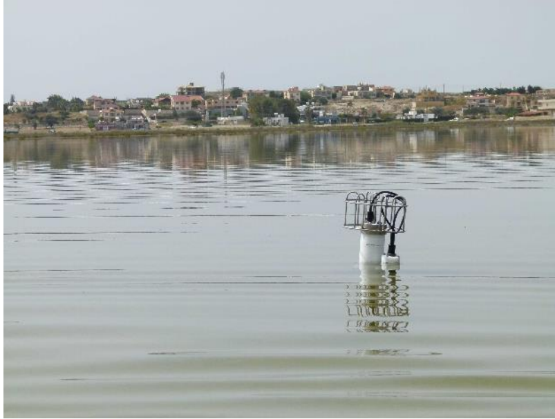
Εικόνα 16. Το όργανο μέτρησης φυσικών και χημικών παραμέτρων (Idronaut CTD 316 Plus).
