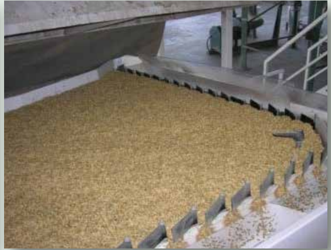
Σποροκαθαριστική μηχανή (τραπέζι βαρύτητας - gravity table)
