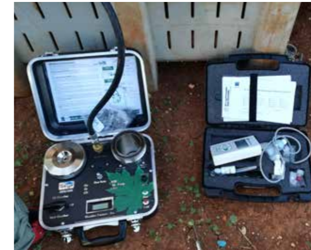
Εικόνα 2: Εξοπλισμός για την καταγραφή της υδατικής κατάστασης του φυτού: Θάλαμος πίεσης (αριστερά) και πορόμετρο (δεξιά)
