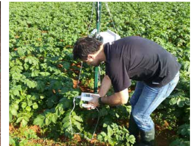
Εικόνα 3: Μέτρηση στοματικής αγωγιμότητας του φυλλώματος της πατάτας με πορόμετρο
